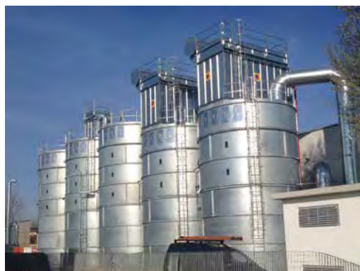
Silos di stoccaggio ATEX per polveri
